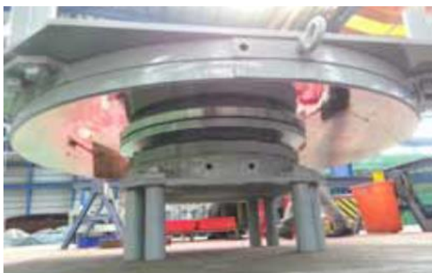
Immagine 26: Isolatori a singola e doppia superficie di scorrimento Hislide HP1 – HP2.
