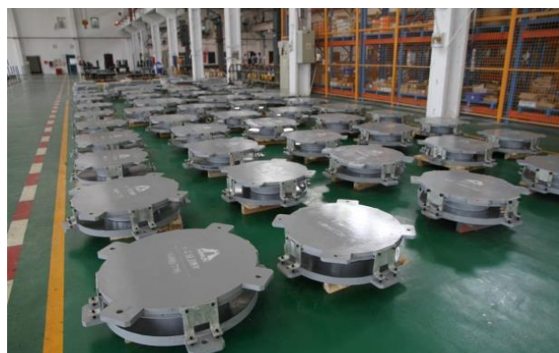
Immagine 26: Isolatori a singola e doppia superficie di scorrimento Hislide HP1 – HP2.
